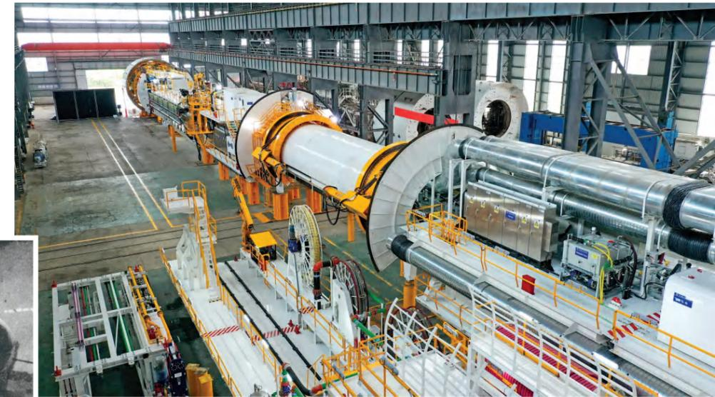
▲2020年，由中国中铁装备集团自主研发的国内最大直径敞开式硬岩掘进机——云岭号在德阳基地顺利下线。1953—2023年四川工业增加值年均增长11.4%，高于全国0.9个百分点，四川工业构建起独具特色的现代化产业体系，奋笔疾书制造强省新篇章。
