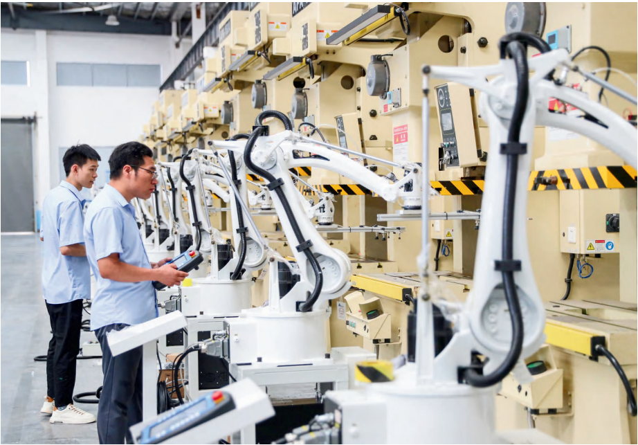
“换”出新动能 以旧换新不仅拉动消费规模，而且促进制造业智能升级。图为华蓥市某科技有限公司工人在智能车间调试新安装的工业机器人。
